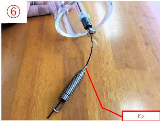
⑥ バネ部先端のピンへワイヤーを差し込む
